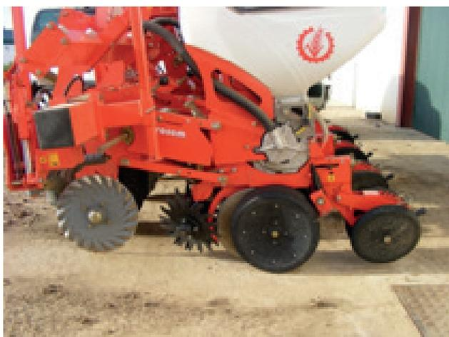
**Figura 6.** Ejemplo de equipo siembra directa compuesto de (comenzando por la izquierda): disco de corte de residuos y preparación previa del terreno; discos tipo "soles" para despeje de restos sobre la línea de siembra; discos abresurcos (van en forma de V) con rueda de goma que actúa como control de profundidad. En el interior va el tubo que deposita las semillas en el suelo; por último, se sitúan los discos de cierre de surco.
