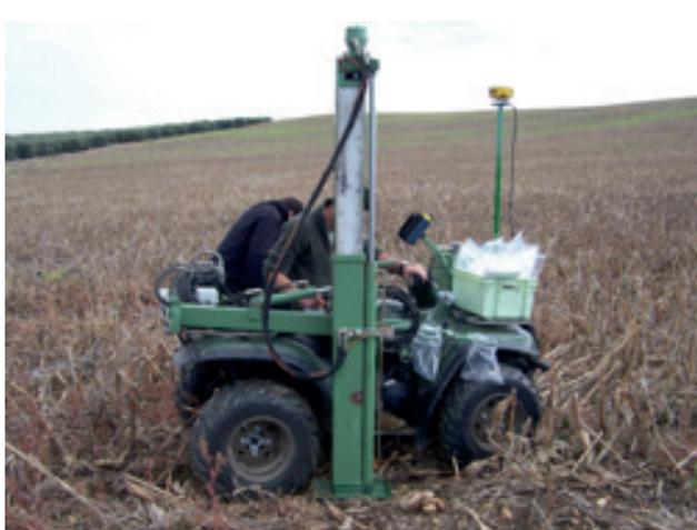
Figura 18. Quad preparado para muestrear suelo
