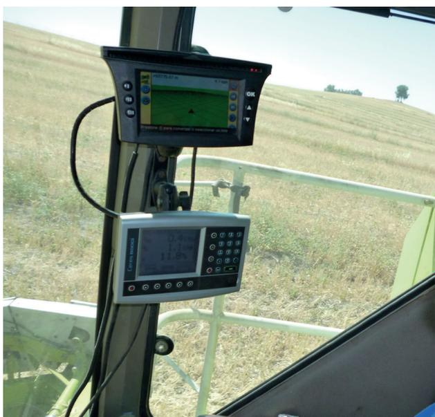
*Figura 3. Sistema de ayuda al guiado mediante barra de luces, arriba, y monitor de rendimiento, abajo, montado en cosechadora.*
