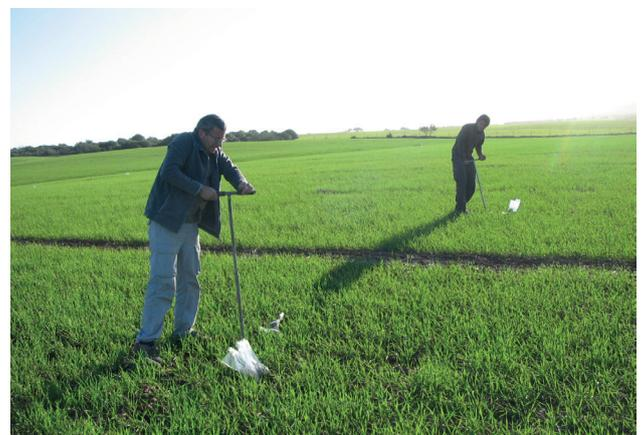
Figura 17. Muestreos simultáneos con barrena para caracterizar una parcela experimental.
