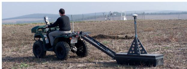
Figura 20. Sonda EM 38 arrastrada por quad
