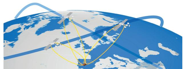
*Figura 2. Triangulación para conocer las coordenadas de un punto terrestre*
