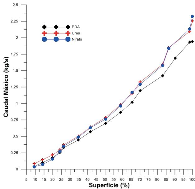
Figura 22. Caudal másico en función de la superficie de apertura de los tres principales abonos utilizados en el cultivo de cereal: fosfato diamónico "PDA", urea y nitrato amónico "Nitrato"
