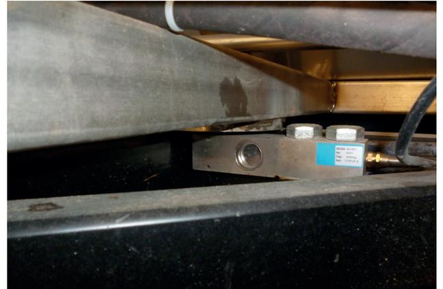
Figura 23. Célula de carga instalada en abonadora
