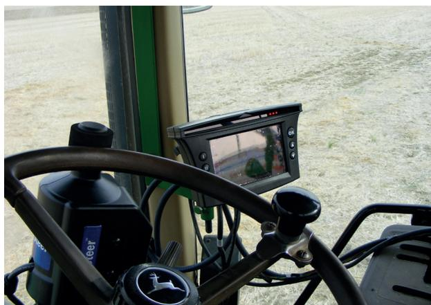
*Figura 4. Sistema de guiado automático móvil "EZSteer" acoplado al volante del tractor*
