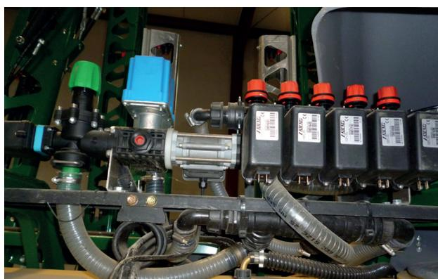
Figura 21. Caudalímetro aforador instalado en una barra de aplicación preparada para la dosificación variable de abono líquido
